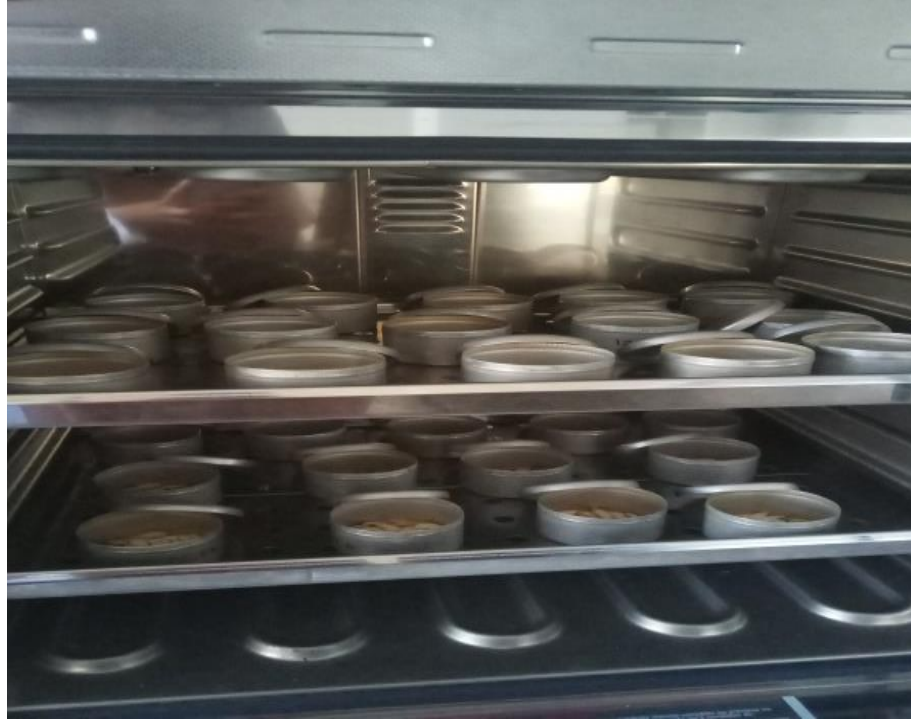
(a) proses pengujian kadar air biji labu menggunakan oven suhu tinggi
