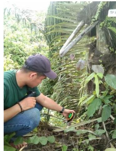
Gambar 9. Mengukur kelembaban tanah
