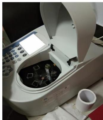
Gambar 18. spektrofotometer
